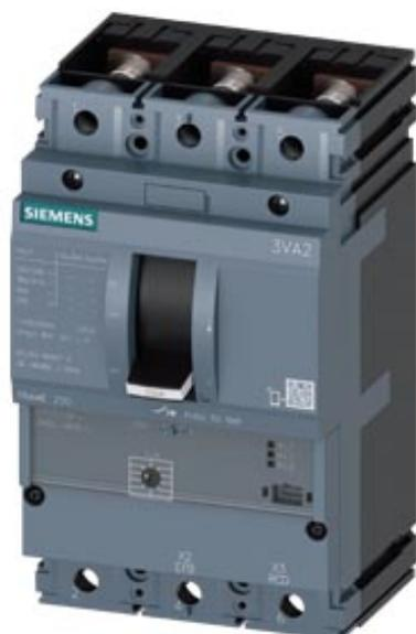
Interruttore automatico 3VA2 IEC Frame 250 Classe del potere di interruzione C Icu=110kA @ 415V a 3 poli, protezione avviatore ETU310M, I, In=200A protezione da sovraccarico Ir=80A...200A protezione da cortocircuito Ii=3...15 x In attacco piatto a vite bobina a lancio di corrente (STL) DC 12-30V, AC 24V 50/60Hz 2 blocchetti di contatti ausiliari HQ 1 contatto di segnalazione intervento HQ 1 blocchetto di contatti di segnalazione intervento di protezione
