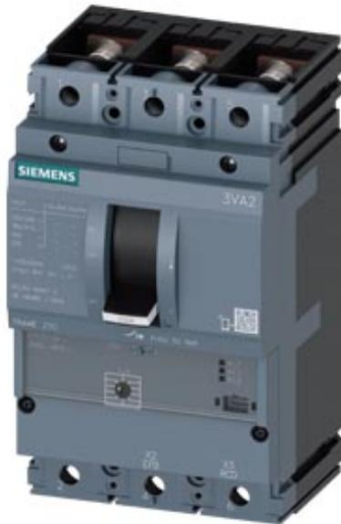
Interruttore automatico 3VA2 IEC Frame 250 Classe del potere di interruzione C Icu=110kA @ 415V a 3 poli, protezione avviatore ETU310M, I, In=200A protezione da sovraccarico Ir=80A...200A protezione da cortocircuito li=3...15 x In attacco piatto a vite bobina a lancio di corrente (STL) DC 220 ... 250 V, 208-277V AC 2 blocchetti di contatti ausiliari HQ
