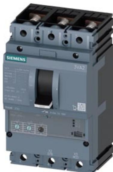
Interruttore automatico 3VA2 IEC Frame 250 Classe del potere di interruzione M Icu=55kA @ 415V a 3 poli, protezione impianto ETU320, LI, In=250A protezione da sovraccarico Ir=100A...250A protezione da cortocircuito li=1,5...10 x In attacco piatto a vite 1 blocchetto di contatti ausiliari HQ 1 blocchetto di contatti di segnalazione intervento HQ
