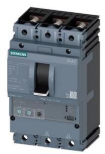
Interruttore automatico 3VA2 IEC Frame 160 classe del potere di interruzione M Icu=55kA @ 415V a 3 poli, protezione motore ETU350M, LSI, In=40A protezione da sovraccarico Ir=16A...40A protezione da cortocircuito Isd=3...15 x Ir, Ii=15 x In attacco piatto a vite bobina a lancio di corrente (STL) DC 220 ... 250 V, 208-277V AC 2 blocchetti di contatti ausiliari HQ
