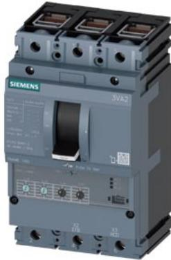
Leistungsschalter 3VA2 IEC Frame 160 Schaltvermögenklasse H Icu=85kA @ 415V 3-polig, Anlagenschutz ETU330, LIG, In=40A Überlastschutz Ir=16A...40A Kurzschlusschutz Ii=1,5...12 x In Erdschlusschutz Ig=0,4...1 x In, tg=0,1/0,3s Klemmenanschluss
