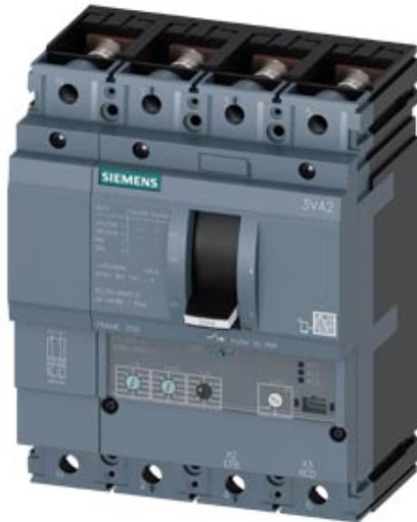
Interruttore automatico 3VA2 IEC Frame 250 Classe del potere di interruzione M Icu=55kA @ 415V a 4 poli, protezione impianto ETU320, LI, In=250A protezione da sovraccarico Ir=100A...250A protezione da cortocircuito li=1,5...10 x In protezione del conduttore di neutro impostabile (OFF, 50%, 100%) attacco piatto a vite bobina di minima tensione (UVR) DC 24 V
