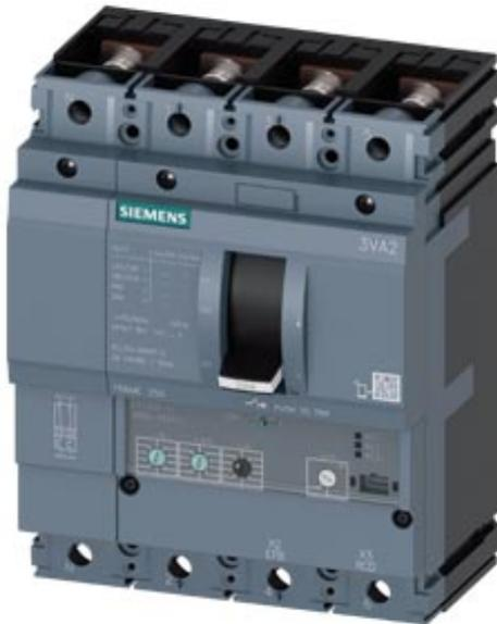
Interruttore automatico 3VA2 IEC Frame 250 Classe del potere di interruzione M Icu=55kA @ 415V a 4 poli, protezione impianto ETU320, LI, In=250A protezione da sovraccarico Ir=100A...250A protezione da cortocircuito li=1,5...10 x In protezione del conduttore di neutro impostabile (OFF, 50%, 100%) attacco piatto a vite bobina di minima tensione (UVR) AC 120 ... 127 V 50/60 Hz 2 blocchetti di contatti ausiliari HQ 1 blocchetto di contatti di segnalazione intervento HQ
