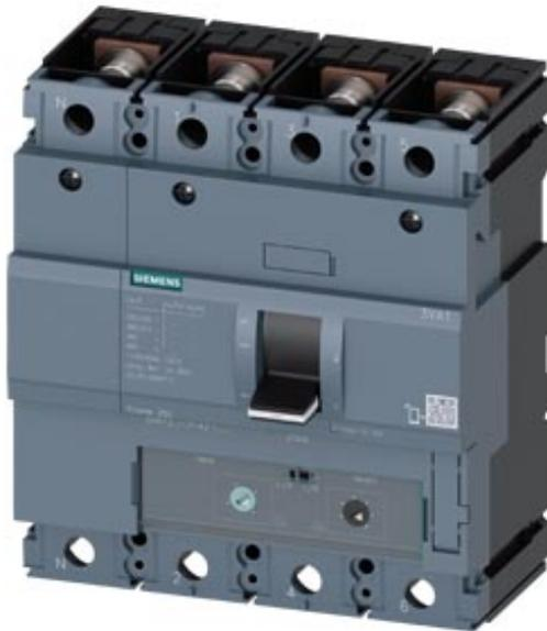
Interruttore automatico 3VA1 IEC Frame 250 Classe del potere di interruzione M Icu=55kA @ 415V a 4 poli, protezione impianto TM240, ATAM, In=250A protezione da sovraccarico Ir=175 A ... 250 A protezione da cortocircuito Ii=5 ... 10 x In protezione del conduttore di neutro 100% attacco piatto a vite bobina a lancio di corrente (STL) 110 ... 127V DC, AC 50/60Hz 2 blocchetti di contatti ausiliari HQ
