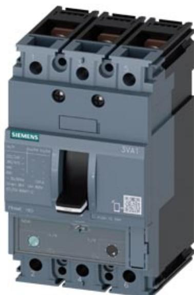
interruttore automatico 3VA1 IEC Frame 160 classe del potere di interruzione M Icu=55kA @ 415V a 3 poli, protezione impianto TM240, ATAM, In=32A protezione da sovraccarico Ir=22 A ... 32 A protezione da cortocircuito li=5...10 x In attacco piatto a vite 1 blocchetto contatti aus. HP 1 blocchetto di contatti di segnalazione intervento HP
