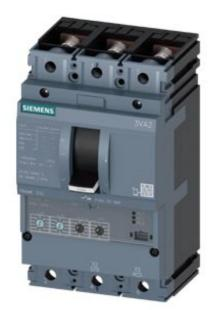
Interruttore 3VA2 IEC Frame 250 Classe del potere di interruzione M Icu=55kA @ 415V a 3 poli, protezione impianto ETU350, LSI, In=250A protezione da sovraccarico Ir=100A...250A protezione da cortocircuito Isd=1,5...10 x Ir, Ii=10 x In attacco piatto a vite bobina di minima tensione (UVR) AC 120 ... 127 V 50/60 Hz 2 blocchetti di contatti ausiliari HQ 1 contatto di segnalazione intervento HQ 1 blocchetto di contatti di segnalazione intervento di protezione
