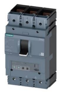
Interruttore 3VA2 IEC Frame 400 Classe del potere di interruzione H Icu=85kA @ 415V a 3 poli, protezione impianto ETU350, LSI, In=400A protezione da sovraccarico Ir=160A...400A protezione da cortocircuito Isd=1,5...10 x Ir, Ii=10 x In attacco piatto a vite 1 blocchetto di contatti ausiliari HQ 1 blocchetto di contatti di segnalazione intervento HQ
