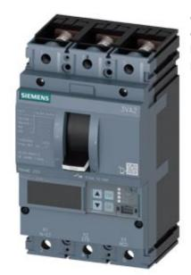
Interruttore 3VA2 IEC Frame 250 Classe del potere di interruzione M Icu=55kA @ 415V a 3 poli, protezione impianto ETU550, LSI, In=250A protezione da sovraccarico Ir=100A...250A protezione da cortocircuito Isd=0,6..10x In, Ii=1,5..10x In protezione del conduttore di neutro opzionale con trasformatore di corrente attacco piatto a vite bobina di minima tensione (UVR) AC 120 ... 127 V 50/60 Hz 2 blocchetti di contatti ausiliari HQ
