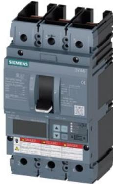
Leistungsschalter 3VA6 UL Frame 250 Schaltvermögenklasse H 65kA @ 480V 3-polig, Anlagenschutz ETU850, LSI, In=100A Überlastschutz Ir=40A...100A Kurzschlusschutz Isd=0,6..10x In, li=1,5..12x In N-Leiterschutz optional mit externem Stromwandler, bis 160% ohne Anschluss
