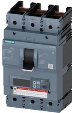
Leistungsschalter 3VA6 UL Frame 600 Schaltvermögenklasse M 35kA @ 480V 3-polig, Anlagenschutz ETU556, LSI, In=400A Überlastschutz Ir=160A...400A Kurzschlusschutz Isd=0,6..10x In, li=1,5..12x In N-Leiterschutz optional mit externem Stromwandler, bis 160% Erdschlussalarm Meldung über EFB300 o. COM ohne Anschluss
