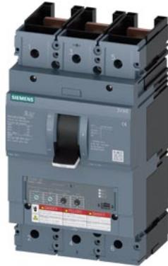
Leistungsschalter 3VA6 UL Frame 600 Schaltvermögenklasse H 65kA @ 480V 3-polig, Anlagenschutz ETU330, LIG, In=400A Überlastschutz, 100% rated Ir=160A...400A Kurzschlusschutz Ii=1,5...12 x In Erdschlusschutz Ig=0,2...1 x In, tg=0,1/0,3s ohne Anschluss
