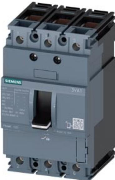
Interruttore automatico 3VA1 IEC Frame 100 Classe del potere di interruzione B Icu=16kA @ 415V a 3 poli, protezione impianto TM210, FTFM, In=63A protezione da sovraccarico Ir=63A impostazione fissa protezione da cortocircuito li=10 x In connessione a morsetto bobina a lancia di corrente (STL) DC 12-30V, AC 24V 50/60Hz 2 blocchetti di contatti ausiliari HQ
