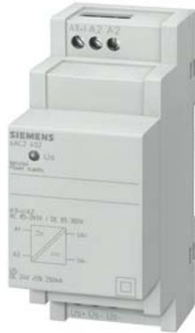
Netzgerät für Dauerbelastung Primär 85..265V AC, 85..300V DC Sekundär DC 24V +-5% Baubr. 2TE Kurzschluss- und Überlastschutz
