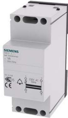
Klingeltransformator, 18VA Primär 230-240V AC, 50Hz, Sekundär 8V, 12V AC mit PTC-Sicherung, 2TE++
