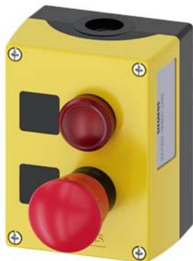
Gehäuse für Befehlsgeräte, 22 mm, rund, Gehäusematerial Kunststoff, Gehäuseoberseite gelb, 2 Befehlsstellen Kunststoff, B=Leuchtmelder rot, LED 24 V, Schraubanschluss, Schild ohne Aufschrift, A=NOT-HALT 40MM DREHENTRIEGELT, Schild ohne Aufschrift, 1S, 1Ö, 1Ö, Schraubanschluss, Bodenbefestigung, oben und unten je 1xM20, Schilder beigelegt
