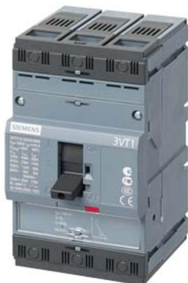
interruttore automatico 3VT1 potere di manovra standard  $I_{cu}=25kA$ , AC 415 V a 3 poli, protezione impianto sganciatore di sovracorrente TM,  $I_n=40A$ , corrente nominale  $I_R=32...40A$ , protezione da sovraccarico  $I_l=200...400A$ , protezione da cortocircuito senza sganciatore ausiliario senza blocchetto di contatti ausiliari/di allarme con collegamenti sul lato frontale
