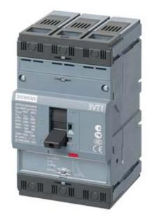
interruttore automatico 3VT1 potere di manovra standard Icu=25kA, AC 415 V a 3 poli, avviatori combinati sganciatore di sovracorrente TM, LIN In=100A, corrente nominale Ii=500 ... 1000 A, protezione da cortocircuito senza sganciatore ausiliario senza blocchetto di contatti ausiliari/di allarme con collegamenti sul lato frontale
