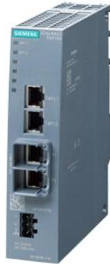
SCALANCE TAP104 Test Access Port zur Telegramm- ausleitung, 2 x RJ45-Ports, 10/100MBit/s, LED-Diagnose, 24V DC Spannungsversorgung, Handbuch.
