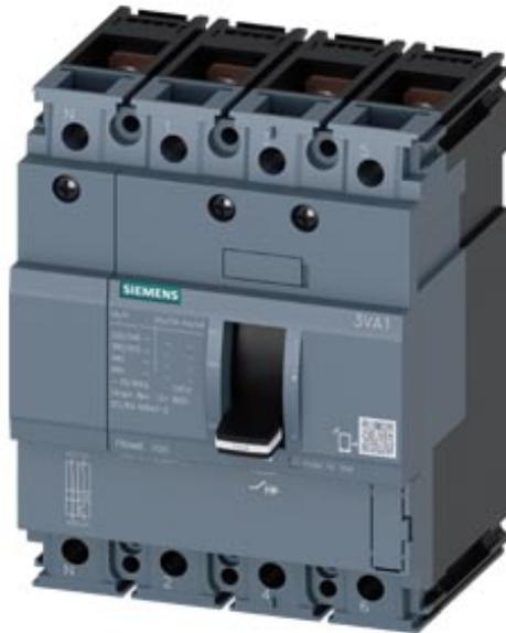
interruttore automatico 3VA1 IEC frame 100 classe del potere di interruzione S Icu=36kA @ 415V a 4 poli, protezione impianto TM210, FTFM, In=63A protezione da sovraccarico Ir=63 A con regolazione fissa protezione da cortocircuito li=10 x In conduttore di neutro non protetto attacco piatto a vite bobina di minima tensione (UVR) AC 208-230 V 50/60 Hz 2 blocchetti contatti aus. HQ
