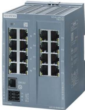
SCALANCE XB216 managebarer Layer 2 IE Switch, 16X 10/100 Mbit/s RJ45 Ports, 1x Konsolen-Port, Diagnose-LED redundante Spannungsversorgung IEC 62443-4-2 zertifiziert; Temp.-Bereich 0°C bis +60°C; Hutschienenmontage, PROFINET IO-Device Ethernet/IP-Zertifikat, Default PROFINET.
