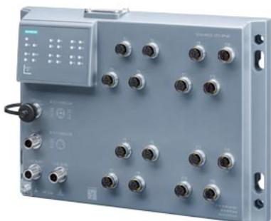
SCALANCE XP216EEC, managed IE Switch, mit Bahn- Zulassung IEC 62443-4-2 zertifiziert; (EN 50155, EN45545); 12x 10/100 Mbit/s M12 Ports, 4x 10/100/1000 Mbit/s M12 Ports IP65, LED-Diagnose, Fehler-Meldekontakt, redundante Spannungsversorgung, PROFINET-IO Device, Netzwerk-Management, im redundanten Ring betreibbar, inkl. Staubschutzkappen, inkl. elektron. Handbuch auf CD-ROM, C-PLUG optional.
