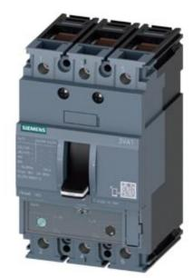
interruttore automatico 3VA1 IEC frame 160 classe del potere di interruzione S Icu=36kA @ 415V a 3 poli, protezione impianto TM240, ATAM, In=125A protezione da sovraccarico Ir=88 A ... 125 A protezione da cortocircuito Ii=5...10 x In connessione a morsetto 2 blocchetti contatti aus. HQ
