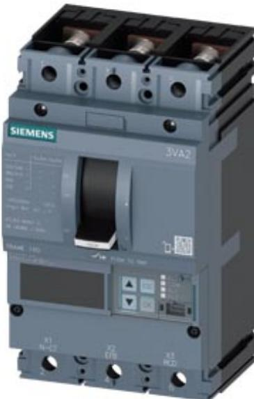
Interruttore automatico 3VA2 IEC Frame 160 classe del potere di interruzione M Icu=55kA @ 415V a 3 poli, protezione impianto ETU550, LSI, In=63A protezione da sovraccarico Ir=25A...63A protezione da cortocircuito Isd=0,6..10x In, Ii=1,5..12x In protezione del conduttore di neutro opzionale con trasformatore di corrente attacco piatto a vite bobina di minima tensione (UVR) 208-230V AC 50/60Hz
