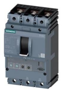
Interruttore automatico 3VA2 IEC Frame 100 Classe del potere di interruzione H Icu=85kA @ 415V a 3 poli, protezione impianto ETU350, LSI, In=63A protezione da sovraccarico Ir=25A...63A protezione da cortocircuito Isd=1,5...10 x Ir, Ii=12 x In attacco piatto a vite bobina a lancio di corrente (STL) DC 12-30V, AC 24V 50/60Hz 2 blocchetti di contatti ausiliari HQ 1 contatto di segnalazione intervento HQ 1 blocchetto di contatti di segnalazione intervento di protezione
