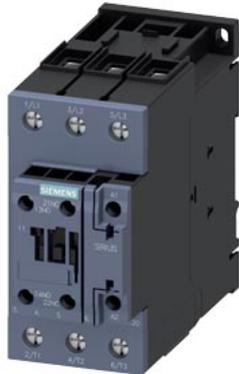
Leistungsschütz, AC-3 51 A, 22 kW / 400 V 1 S + 1 Ö, DC 24 V mit Varistor, 3-polig, Baugröße S2, Schraubanschluss stehende Einbaulage geeignet für 2 A SPS-Ausgänge
