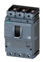
Leistungsschalter 3VA2 IEC Frame 160 Schaltvermögenklasse L lcu=150kA @ 415V 3-polig, Anlagenschutz ETU340, ELISA LI, In=63A Überlastschutz Ir=25A...63A Kurzschlussschutz li=15 x In Schraubenflachanschluss
