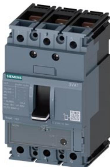
interruttore automatico 3VA1 IEC Frame 160 classe del potere di interruzione M Icu=55kA @ 415V a 3 poli, protezione avviatore TM120M, AM, In=125A senza protezione da sovraccarico protezione da cortocircuito Ii=5...15 x In attacco piatto a vite 1 blocchetto contatti aus. HP 1 blocchetto di contatti di segnalazione intervento HP
