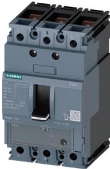
interruttore automatico 3VA1 IEC Frame 160 classe del potere di interruzione M Icu=55kA @ 415V a 3 poli, protezione avviatore TM120M, AM, In=125A senza protezione da sovraccarico protezione da cortocircuito Ii=5...15 x In attacco piatto a vite bobina di minima tensione (UVR) AC 208-230 V 50/60 Hz
