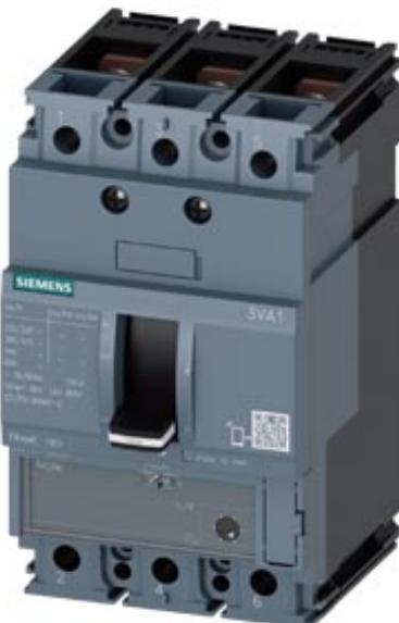
interruttore automatico 3VA1 IEC Frame 160 classe del potere di interruzione M Icu=55kA @ 415V a 3 poli, protezione avviatore TM120M, AM, In=125A senza protezione da sovraccarico protezione da cortocircuito li=5...15 x In attacco piatto a vite bobina a lancio di corrente (STL) 110 ... 127V DC, AC 50/60Hz 2 blocchetti contatti aus. HQ
