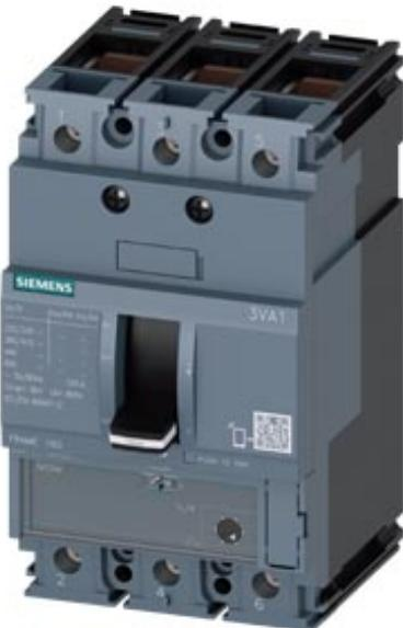
interruttore automatico 3VA1 IEC Frame 160 classe del potere di interruzione M Icu=55kA @ 415V a 3 poli, protezione avviatore TM120M, AM, In=125A senza protezione da sovraccarico protezione da cortocircuito li=5...15 x In connessione a morsetto 2 blocchetti contatti aus. HQ 1 blocchetto di contatti di segnalazione intervento HQ
