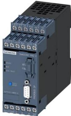
Grundgerät SIMOCODE pro V PB, PROFIBUS DP-Schnittstelle 12 MBit/s, RS-485, 4E/3A frei parametrierbar, US: 24 V DC, Eingang für Thermistoranschluss monostabile Relais-Ausgänge, erweiterbar durch Erweiterungsmodule
