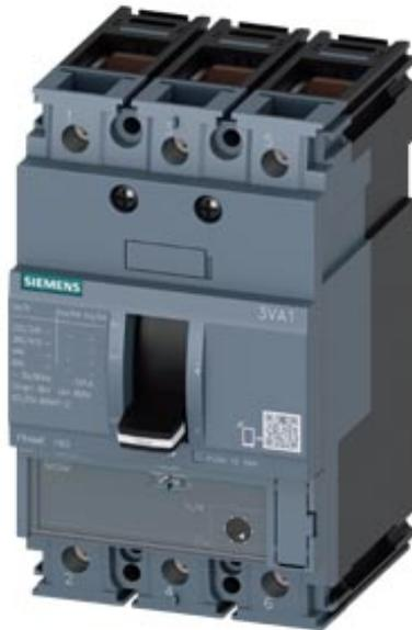
Interruttore automatico 3VA1 IEC Frame 160 Classe del potere di interruzione H Icu=70kA @ 415V a 3 poli, protezione avviatore TM120M, AM, In=63A senza protezione da sovraccarico protezione da cortocircuito Ii=5...15 x In connessione a morsetto bobina a lancio di corrente (STL) DC 220-250 V; AC 208-277 V
