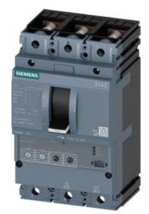
Interruttore automatico 3VA2 IEC Frame 160 classe del potere di interruzione M Icu=55kA @ 415V a 3 poli, protezione impianto ETU350, LSI, In=100A protezione da sovraccarico Ir=40A...100A protezione da cortocircuito Isd=1,5...10 x Ir, Ii=12 x In attacco piatto a vite bobina di minima tensione (UVR) 208-230V AC 50/60Hz 2 blocchetti di contatti ausiliari HQ
