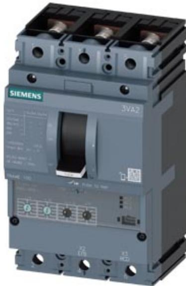
Interruttore automatico 3VA2 IEC Frame 100 Classe del potere di interruzione M Icu=55kA @ 415V a 3 poli, protezione impianto ETU350, LSI, In=63A protezione da sovraccarico Ir=25A...63A protezione da cortocircuito I<sub>sd</sub>=1,5...10 x I<sub>r</sub>, I<sub>i</sub>=12 x I<sub>n</sub> attacco piatto a vite bobina di minima tensione (UVR) AC 120 ... 127 V 50/60 Hz 2 blocchetti di contatti ausiliari HQ
