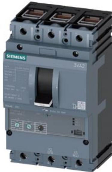
Interruttore automatico 3VA2 IEC Frame 160 classe del potere di interruzione  $M_{lcu}=55kA @ 415V$  a 3 poli, protezione motore ETU350M, LSI,  $I_n=63A$  protezione da sovraccarico  $I_r=25A...63A$  protezione da cortocircuito  $I_{sd}=3...15 \times I_r$ ,  $I_i=15 \times I_n$  connessione a morsetto bobina a lancio di corrente (STL) DC 220 ... 250 V, 208-277V AC 2 blocchetti di contatti ausiliari HQ
