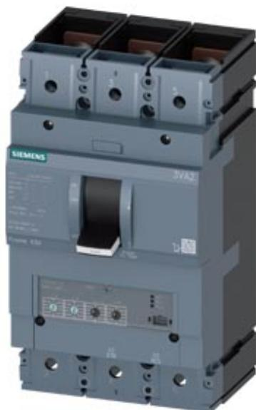
Interruttore 3VA2 IEC Frame 630 Classe del potere di interruzione C Icu=110kA @ 415V a 3 poli, protezione impianto ETU350, LSI, In=630 A protezione da sovraccarico Ir=250 A ... 630 A protezione da cortocircuito I<sub>sd</sub>=1,5...9 x I<sub>r</sub>, I<sub>i</sub>=9 x I<sub>n</sub> attacco piatto a vite 4 blocchetti di contatti ausiliari HQ
