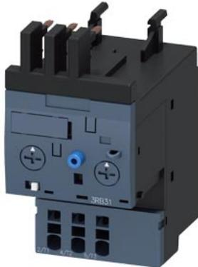
Überlastrelais 0,1...0,4 A elektronisch für Motorschutz Baugröße S00, CLASS 5...30 Schützenbau Hauptstromkreis: Federzugklemme Hilfsstromkreis: Federzugklemme Hand-Automatik-RESET interne Erdschlusserkennung
