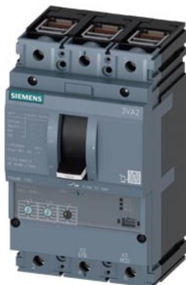
Interruttore automatico 3VA2 IEC Frame 160 Classe del potere di interruzione H Icu=85kA @ 415V a 3 poli, protezione impianto ETU320, LI, In=63A protezione da sovraccarico Ir=25A...63A protezione da cortocircuito li=1,5...12 x In connessione a morsetto 2 blocchetti di contatti ausiliari HQ
