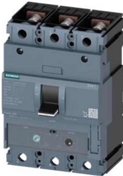
Interruttore automatico 3VA1 IEC Frame 250 Classe del potere di interruzione M Icu=55kA @ 415V a 3 poli, protezione impianto TM240, ATAM, In=160A protezione da sovraccarico Ir=112 A ... 160 A protezione da cortocircuito Ii=5 ... 10 x In attacco piatto a vite bobina di minima tensione (UVR) DC 24 V
