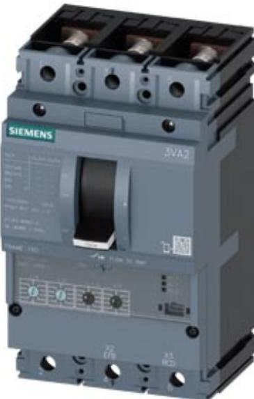
Interruttore automatico 3VA2 IEC Frame 160 Classe del potere di interruzione C Icu=110kA @ 415V a 3 poli, protezione impianto ETU350, LSI, In=63A protezione da sovraccarico Ir=25A...63A protezione da cortocircuito Isd=1,5...10 x Ir, li=12 x In attacco piatto a vite 1 blocchetto di contatti ausiliari HP 1 blocchetto di contatti di segnalazione intervento HP
