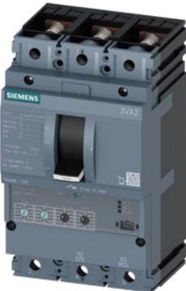
Interruttore automatico 3VA2 IEC Frame 160 Classe del potere di interruzione C Icu=110kA @ 415V a 3 poli, protezione impianto ETU350, LSI, In=63A protezione da sovraccarico Ir=25A...63A protezione da cortocircuito Isd=1,5...10 x Ir, li=12 x In attacco piatto a vite bobina di minima tensione (UVR) 208-230V AC 50/60Hz 2 blocchetti di contatti ausiliari HQ 1 contatto di segnalazione intervento HQ 1 blocchetto di contatti di segnalazione intervento di protezione
