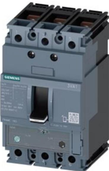
Interruttore automatico 3VA1 IEC Frame 160 Classe del potere di interruzione H Icu=70kA @ 415V a 3 poli, protezione impianto TM240, ATAM, In=80A protezione da sovraccarico Ir=56 A ... 80 A protezione da cortocircuito Ii=5 ... 10 x In attacco piatto a vite bobina di minima tensione (UVR) DC 24 V
