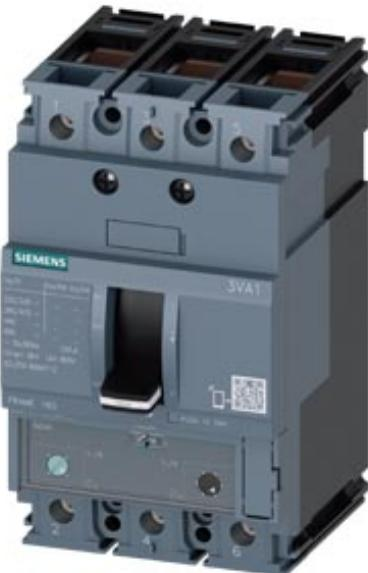
Interruttore automatico 3VA1 IEC Frame 160 Classe del potere di interruzione S Icu=36kA @ 415V a 3 poli, protezione impianto TM240, ATAM, In=16 A protezione da sovraccarico Ir=11 A ... 16 A protezione da cortocircuito li=10 ... 20 x In connessione a morsetto 2 blocchetti di contatti ausiliari HQ 1 blocchetto di contatti di segnalazione intervento HQ
