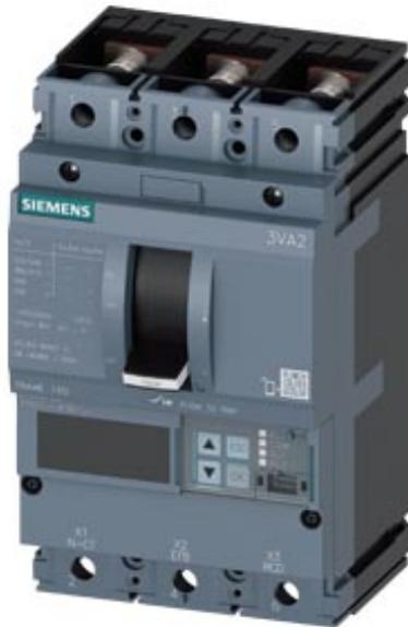
Interruttore automatico 3VA2 IEC Frame 160 classe del potere di interruzione  $M I_{cu}=55kA @ 415V$  a 3 poli, protezione impianto ETU550, LSI,  $I_n=100A$  protezione da sovraccarico  $I_r=40A...100A$  protezione da cortocircuito  $I_{sd}=0,6..10x I_n$ ,  $I_i=1,5..12x I_n$  protezione del conduttore di neutro opzionale con trasformatore di corrente attacco piatto a vite 4 blocchetti di contatti ausiliari HQ
