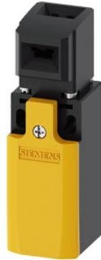
Sicherheits-Positionsschalter mit getrenntem Betätiger Metallgehäuse 31 mm, 1x (M20x 1,5), EN 50047 Schleichschaltglieder 1S+1Ö 5 Anfahrrichtungen der dazu passende getrennte Betätiger 3SE5000-0AV0./-0AW. muss separat bestellt werden
