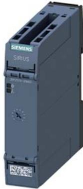
Zeitrelais, elektronisch mit Stern-Dreieck-Funktion 1S verzögert 1S unverzögert 1 Zeitbereich, 1...20 s AC 200-240 V und AC 380-440 V mit LED, Federzuganschluss (Push-In)
